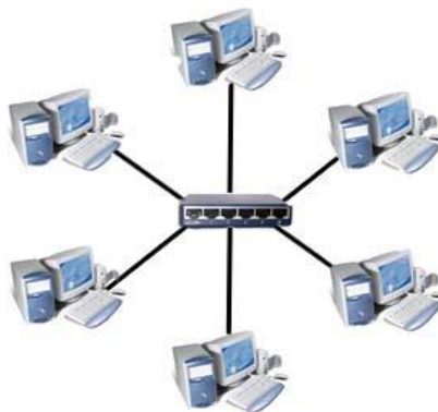
รูปที่ 1.14 การเชื่อมต่อแบบสตาร์ ที่มา : เอกชัย ไก่แก้ว (2556)
